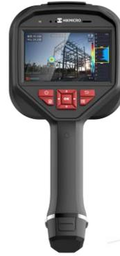
海康微影AP56声波成像仪是一款专业的声源定位产品。凭借64个低噪声MEMS麦克风和从2 kHz到65 kHz的可调带宽范围，AP56提供了一种简单有效的方法来定位工业环境中的加压空气泄漏或检测高压系统中的局部放电。采用4.3英寸大液晶触摸屏，数字图片上显示的结果，让您快速找到问题的根源。最大操作距离可达100 m，确保您在安全距离内进行检查。采用这种轻巧易用的工具，您可以发现潜在的安全风险，最大限度地减少故障排除，并节省设备故障和停机时间的额外成本。
