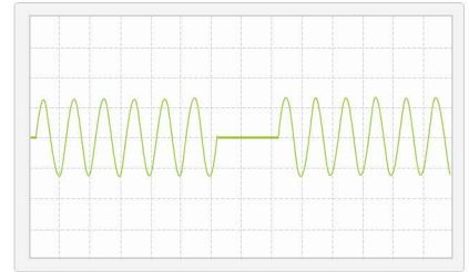
线路编程 (Sim) 仿真电压突降输出
