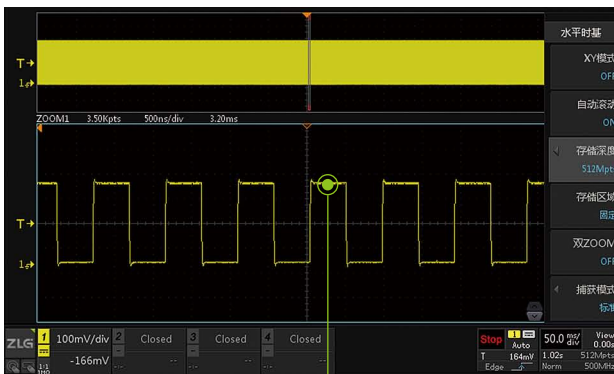
512 M 存储深度，捕获 1024ms 波形，采样率依然高达 500 MHz，波形完全没有失真
